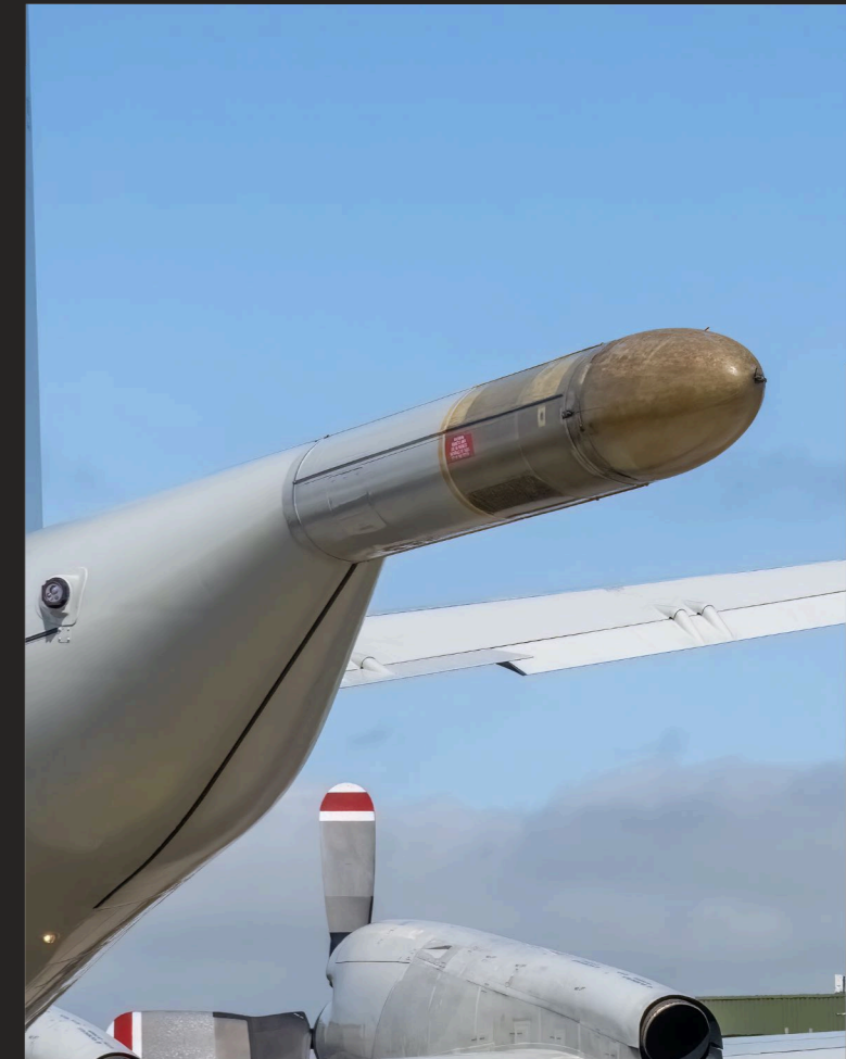
Magnetischer Anomalie Detektor(MAD)
