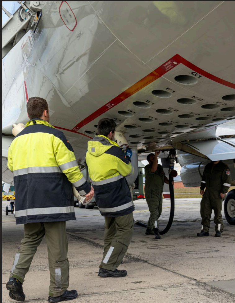
Laden einer Sonoboje in den Launcher
