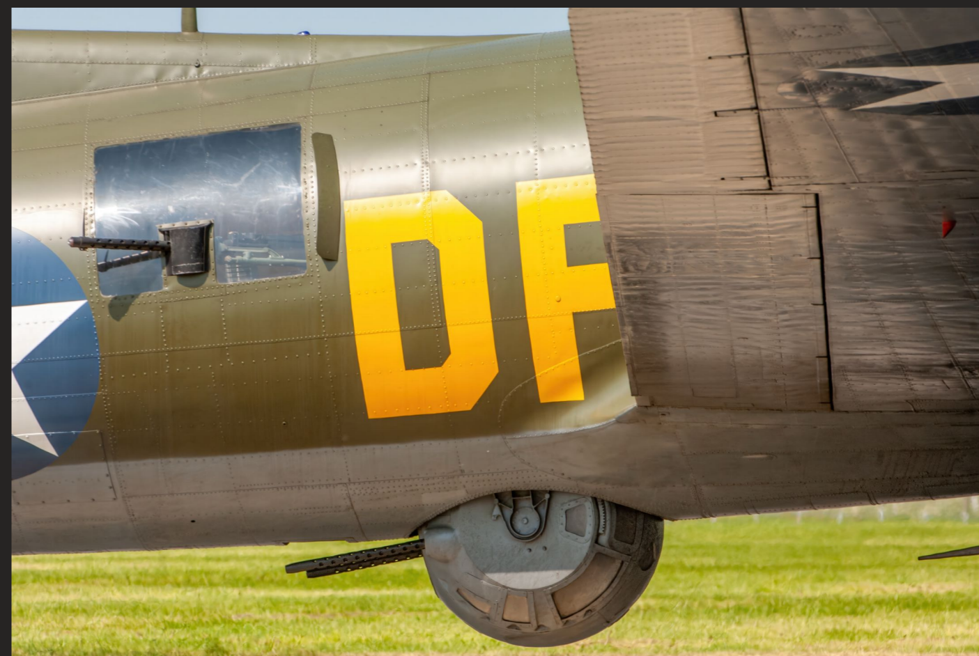
Positions de la tourelle-boule et des mitrailleurs latéraux / photo de : Robert Kysela
